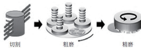
图3 多线切割工艺原理
